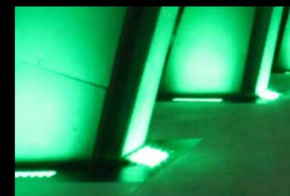
Pour les éclairer, c'est un éclairage rasant, diminuant progressivement, qui a été choisi. Pour cette mise en lumière, une rangée de projecteurs Onyx, configurée en couleurs RVBB, a été installée, juste devant chacune des 26 colonnes.
