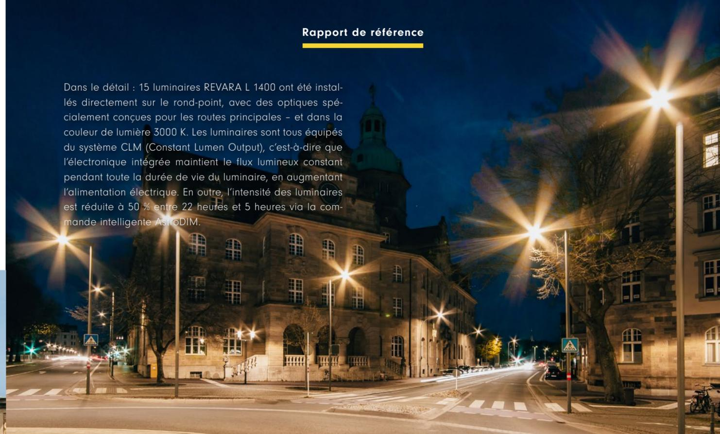
Le chemin entourant le rond-point a été rééquipé de 16 têtes lumineuses RESIDENZA sur double console. Les luminaires à LED sont équipés d'une optique O8 (répartition lumineuse à symétrie de révolution) et disposent aussi d'une fonction CLM. La couleur de la lumière est ici aussi de 3000 K. Grâce à la commande intelligente AstroDIM,
