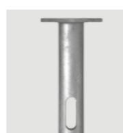
Élément de base en tube d'aluminium, Ø 230mm. Hauteur d'élément minimum : 150 mm. Pieu d'ancrage : en continu à l'embase de l'élément, longueur : 600 mm. Avec deux ouvertures pour entrée de câble. Fixation avec éléments de terminaison le surmontant, par vissage intérieur. Couleurs: DB 703 ou toutes les couleurs RAL (classic, uni), toutes les couleurs Hess DB et Hess Glimmer (satinées métallisées, à effet micacé). RAL nacré - micacé - tons métalliques, uniquement sur demande.
