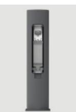
Élément de base en tube d'aluminium pour une hauteur totale de borne de 1200 mm, Ø 180 mm. Avec porte de visite et rail en C pour boîtier de raccordement et unité d'alimentation. Porte avec sortie de câble et serrure cylindrique pour fonctionnement avec porte fermée. Hauteur de l'élément 820 mm.
