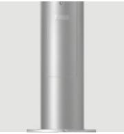
Élément de base en tube d'aluminium, Ø 230mm, avec trappe d'inspection. Équipement: rail en C pour accrochage d'un boîtier de raccordement à fournir par le maître d'ouvrage. Hauteur d'élément minimum : 800 mm externe. Peint. Fixation hors sol au moyen d'une platine de fixation soudée. Couleurs: DB 703 ou toutes les couleurs RAL (classic, uni), toutes les couleurs Hess DB et Hess Glimmer (satinées métallisées, à effet micacé). RAL nacré - micacé - tons métalliques, uniquement sur demande.
