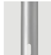
Élément de base en tube d'aluminium, Ø 230mm, avec trappe d'inspection pour boîtier de raccordement à fournir par le maître d'ouvrage et porte pour unité d'alimentation (électricité). Hauteur minimum d'élément hors sol : 1700 mm. Fixation : embase de l'élément sert de pieu d'ancrage. Couleurs: DB 703 ou toutes les couleurs RAL (classic, uni), toutes les couleurs Hess DB et Hess Glimmer (satinées métallisées, à effet micacé). RAL nacré - micacé - tons métalliques, uniquement sur demande.
