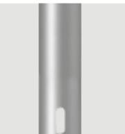
Grundelement aus Aluminiumrohr, Ø 180 mm, für eine Säulen-Gesamthöhe bis 6000 mm. Elementhöhe kundenspezifisch min. 2200 mm. Befestigung über Erdstück am Mast. Erdstücklänge 800 mm mit zwei Kabel-Einführungsöffnungen. Mit Revisionstür und C-Schiene für Kabelübergangskasten. Farbe: DB 703 oder alle RAL- (classic- uni Farbtöne), Hess-DB- und Hess-Glimmer-Farben. RAL Perl-Glimmer-Metallic-Töne auf Anfrage.
