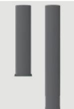
Grundelement aus Aluminiumrohr für eine Poller-Gesamthöhe von 1200 mm, Ø 180 mm. Ohne Revisionstür. Elementhöhe 820 mm. Bei CR 02/04 Befestigung außen mit angeschweißtem Flanschplatte, Q200/10 mm. Separates Erdstück aus Stahl, verzinkt. Bei CR 03 Befestigung über Erdstück am Mast, Erdstücktiefe 500 mm. Farbe: DB 703 oder alle RAL- (classic- uni Farbtöne), Hess-DB- und Hess-Glimmer-Farben. RAL Perl-Glimmer-Metallic-Töne auf Anfrage.
