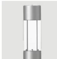
Abschlusselement aus Aluminium, Ø 230 mm, für rotations- oder asymmetrische Platz- oder Straßenbeleuchtung, mit seitlicher Revisionstür. Leuchtenglas aus zylindrischem PMMA. Elementhöhe 900 mm.
