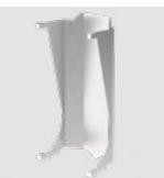
Abschatter CITY ELEMENTS 180 - Lichtpoller. Für Abschlusselement - Lichtpoller AR. Aus Edelstahl, gebürstet. Abschattung 120°. Einbau innerhalb des Glases.
