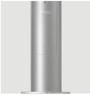
Grundelement aus Aluminiumrohr, Ø 230 mm, mit Revisionsöffnung. Ausstattung mit C-Schiene zur Aufnahme des bauseitigen Kabelübergangskastens. Elementhöhe min. 2100 mm über der Erde, lackiert. Befestigung außen mit angeschweißtem Flansch. CRo4 nur mit Flanschplatte. Zubehör: Separates Erdstück aus Stahl, verzinkt (CRo2). Farbe: DB 703 oder alle RAL- (classic- uni Farbtöne), Hess-DB- und Hess-Glimmer-Farben. RAL Perl-Glimmer-Metallic-Töne auf Anfrage.
