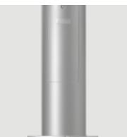
Grundelement aus Aluminiumrohr, Ø 180 mm, mit Revisionsöffnung für bauseitigen Kabelübergangskasten und Tür für Versorgungseinheit. Elementhöhe min. 2200 mm über der Erde. Befestigung außen mit angeschweißtem Flansch. CRVo4 nur mit Flanschplatte. Zubehör: Separates Erdstück aus Stahl, verzinkt (CRVo2). Farbe: DB 703 oder alle RAL- (classic- uni Farbtöne), Hess-DB- und Hess-Glimmer-Farben. RAL Perl-Glimmer-Metallic-Töne auf Anfrage.
