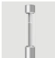
Abschlusselement aus Aluminium, Ø 230 mm, für rotations- oder asymmetrische Platz- oder Straßenbeleuchtung, mit seitlicher Revisionstür. Leuchtenglas aus zylindrischem PMMA. Elementhöhe 1400 mm.
