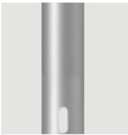
Grundelement aus Aluminiumrohr, Ø 230 mm, mit Revisionsöffnung. Ausstattung mit C-Schiene zur Aufnahme des bauseitigen Kabelübergangskastens. Elementhöhe min. 2100 mm über der Erde, lackiert. Befestigung über Erdstück am Mast. Erdstücktiefe 800 oder 1200 mm gemäß Gesamthöhe der Säulenleuchte. Farbe: DB 703 oder alle RAL- (classic- uni Farbtöne), Hess-DB- und Hess-Glimmer-Farben. RAL Perl-Glimmer-Metallic-Töne auf Anfrage.
