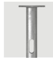
Separates Erdstück 180 CRo2/CRVo2. Aus Stahl, verzinkt. Mit Verbindungsschrauben. Erdstücklänge 800 mm. Mit zwei Kabel-Einführungsöffnungen.
