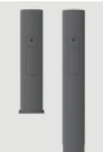
Grundelement aus Aluminiumrohr für eine Poller-Gesamthöhe von 1200 mm, Ø 180 mm. Mit Revisionstür und C-Schiene für Kabelübergangskasten. Elementhöhe 820 mm. Bei CR 02/04 Befestigung außen mit angeschweißtem Flanschplatte, Q200/10 mm. Separates Erdstück aus Stahl, verzinkt. Bei CR 03 Befestigung über Erdstück am Mast, Erdstücktiefe 500 mm. Farbe: DB 703 oder alle RAL- (classic- uni Farbtöne), Hess-DB- und Hess-Glimmer-Farben. RAL Perl-Glimmer-Metallic-Töne auf Anfrage.
