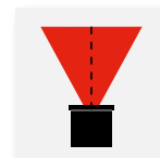
Réflecteur 20% scat Y_{10\%} = 2 \times 22,6^\circ Y_{50\%} = 2 \times 13^\circ
