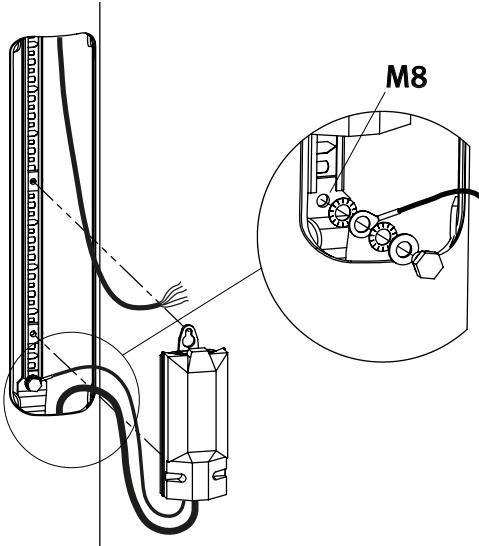
(D) Der Kabelübergangskasten ist nicht im Lieferumfang enthalten, er muss VDE, ENEC und für die Montage auf C-Schienen zugelassen sein, sowie der Schutzklasse und Schutzart der Leuchte entsprechen. Die Schraubenanschlussklemmen müssen für das Auflegen der verwendeten Kabel zugelassen sein.
