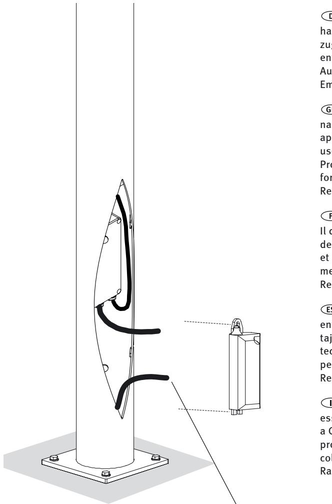
**D** Der Kabelübergangskasten ist nicht im Lieferumfang enthalten, er muss VDE, ENEC und für die Montage auf C-Schienen zugelassen sein, sowie der Schutzklasse und Schutzart der Leuchte entsprechen. Die Schraubenanschlussklemmen müssen für das Auflegen der verwendeten Kabel zugelassen sein.
