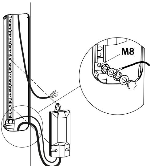
(D) Der Kabelübergangskasten ist nicht im Lieferumfang enthalten, er muss VDE, ENEC und für die Montage auf C-Schienen zugelassen sein, sowie der Schutzklasse und Schutzart der Leuchte entsprechen. Die Schraubenanschlussklemmen müssen für das Auflegen der verwendeten Kabel zugelassen sein.
