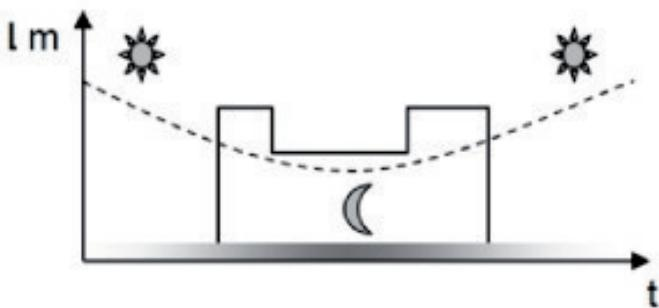
(D) NachtabSENKUNG über Steuerleitung
