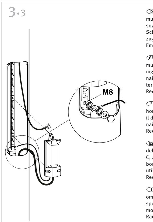
Ⓓ Der Kabelübergangskasten ist nicht im Lieferumfang enthalten, er muss VDE, ENEC und für die Montage auf C-Schienen zugelassen sein, sowie der Schutzklasse und Schutzart der Leuchte entsprechen. Die Schraubenanschlussklemmen müssen für das Auflegen der verwendeten Kabel zugelassen sein.
