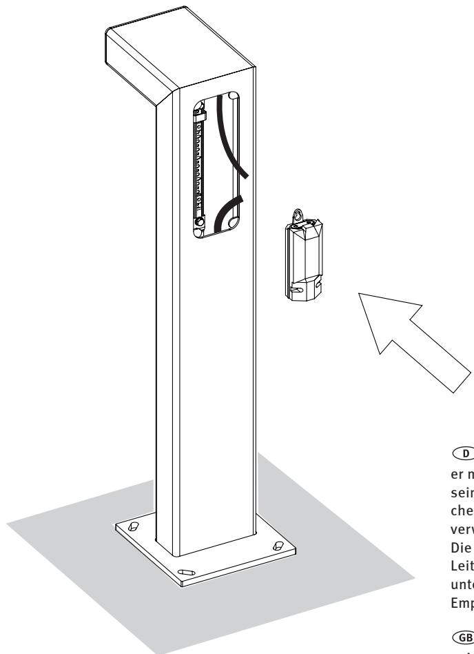
**D** Der Kabelübergangskasten ist nicht im Lieferumfang enthalten, er muss VDE, ENEC und für die Montage auf C-Schienen zugelassen sein, sowie der Schutzklasse und Schutzart der Leuchte entsprechen. Die Schraubenanschlussklemmen müssen für das Auflegen der verwendeten Kabel zugelassen sein.
