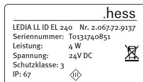
**D** VORSICHT: Zerstörungsgefahr. Spannung vom Transformator zur 1. LEDIA muss der eingetragenen Betriebsspannung auf dem Typenschild entsprechen. Spannungsverluste durch lange Zuleitungen können durch das am Transformator vorhandene Potentiometer nachgeregelt werden.
