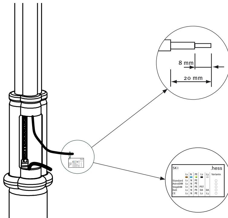
**D** Der Kabelübergangskasten ist nicht im Lieferumfang enthalten, er muss VDE, ENEC und für die Montage auf C-Schienen zugelassen sein, sowie der Schutzklasse und Schutzart der Leuchte entsprechen. Die Schraubenanschlussklemmen müssen für das Auflegen der verwendeten Kabel zugelassen sein.
