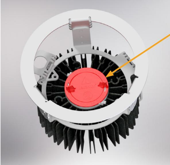
Vor Inbetriebnahme muss die rote Schutzkappe entfernt und anschließend der Reflektor aufgesetzt werden.
