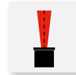
Reflektor 0% scat Y_{10\%} = 2 \times 6,6^\circ Y_{50\%} = 2 \times 3,6^\circ
