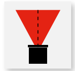
Reflektor 20% scat Y_{10\%} = 2 \times 22,6^\circ Y_{50\%} = 2 \times 13^\circ
