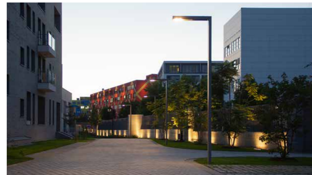
Funktionalität und Atmosphäre: Bei der Beleuchtung wurde beides berücksichtigt. Während die Wege homogen und flächig ausgeleuchtet werden, werden besondere Elemente – wie hier die Außenmauer – sehr atmosphärisch in Szene gesetzt.
