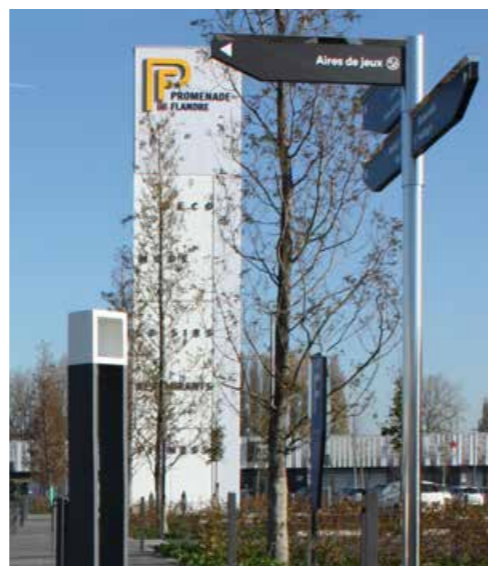
Diverse Absperrpoller wurden – für eine bessere Wahrnehmung für Menschen mit Sehbehinderung – am Kopf des Pollers in weiß lackiert.
